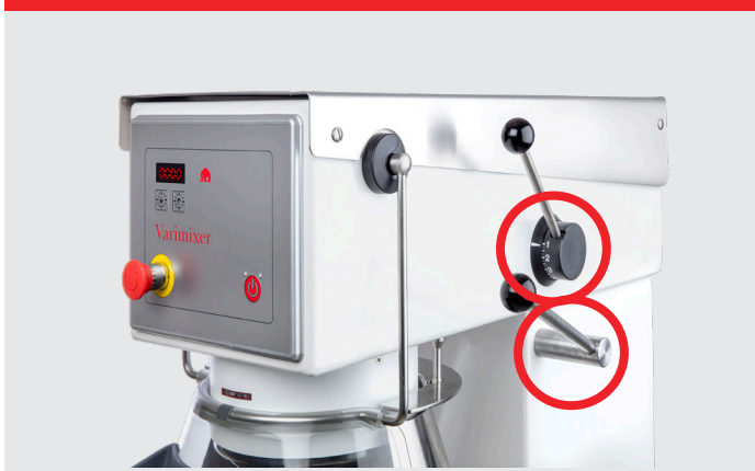
VL-1 – Manuelle Drehzahlregelung und manuelle Kesselablenkung
