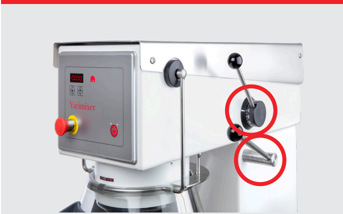
VL-1 – Manuelle Drehzahlregelung und manuelle Kesselabsenkung
