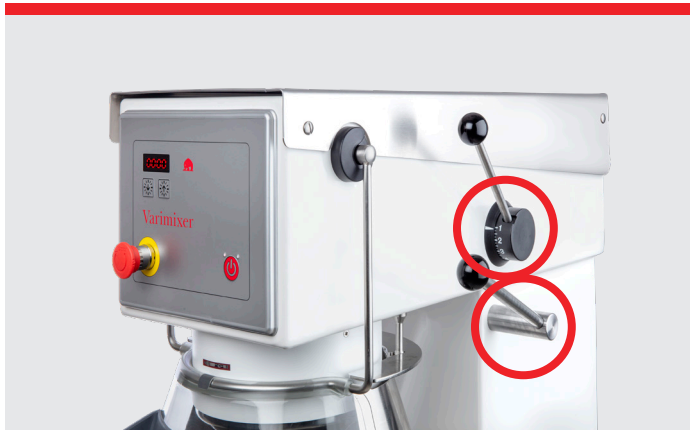
VL-1 – Régulation de la vitesse manuelle et abaissement manuel de la cuve
