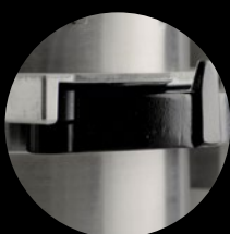
Automatisk fastspænding og centrering af kedel
