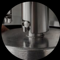
Fastgørelse af værktøj Nem selvåbende bajonetaksel
